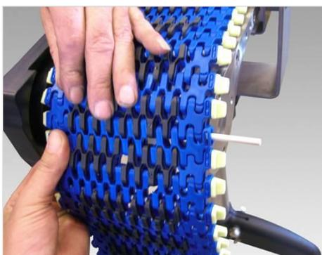
6. An der Montageöffnung den Verbindungsstab montieren und damit die Kette schließen.
