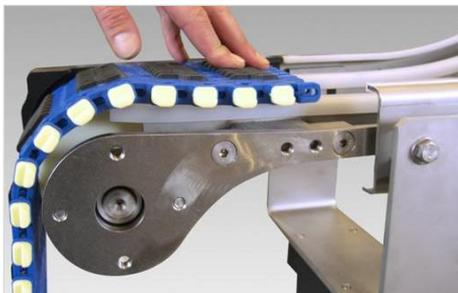
3. Die Kette in Laufrichtung in die Umlenkung einführen und nachschieben/ziehen, bis die Kette komplett durch den Förderer durchgezogen ist.
