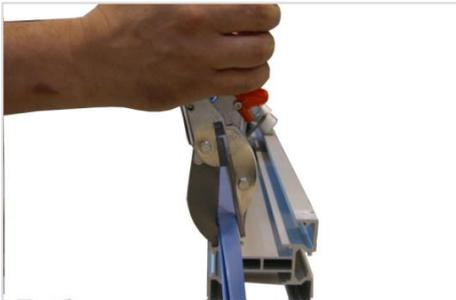
10. Gleitleiste am Ende des Chassisprofils (in Laufrichtung gesehen) gerade abschneiden und bündig aufclipsen.
