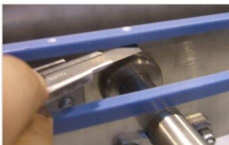
18. Bei Chassisprofilen den Schraubenkopf auch von unten (Kettenlauf-Fläche) sorgfältig und bündig abschneiden.
