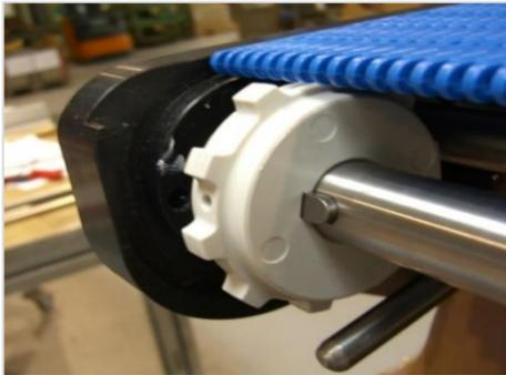
1. Mit einem kurzen Kettenstück den Lauf überprüfen.
