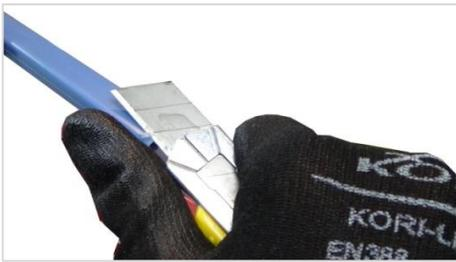
2. Gleitprofile auf Beschädigung prüfen.
