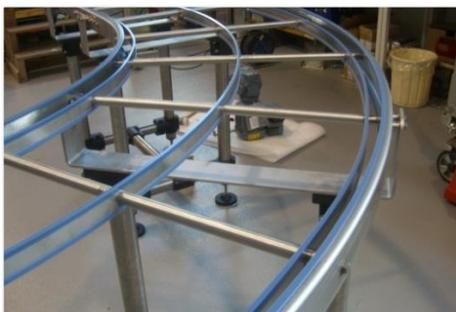
4. Die Gleitprofile in Laufrichtung bis an den Anschlag aufdrücken.
