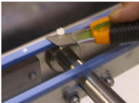
16. Bei Profilen, bei denen die Förderkette aufliegt (Kettenlauf-Flächen) den Schraubenkopf sorgfältig und bündig abschneiden.
