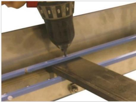
12. Jedes Gleitprofilstück muss am Anfang (in Laufrichtung gesehen) fixiert werden.
