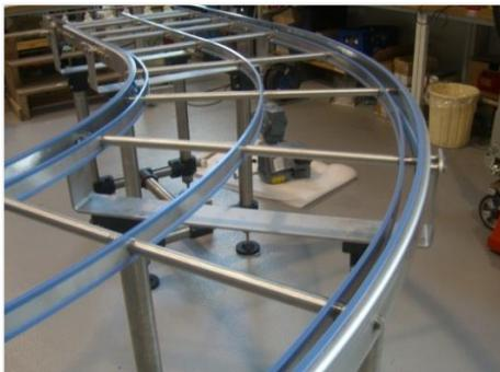
4. Gleitprofile in Laufrichtung auf die Oberseite der Halteprofil aufdrücken.
