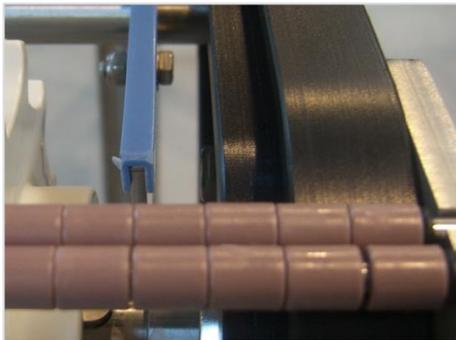
14. Vor Zwischenelementen oder nachfolgenden Elementen das Gleitprofil am Ende des Halteprofils (in Laufrichtung gesehen) bündig montieren.
