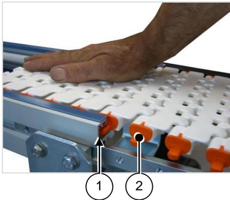
1. Ein Seitenteil an der Umlenkung demontieren.
