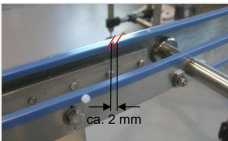
5. Gleitprofilestöße mit einem Spalt von ca. 2 mm und versetzt montieren.
