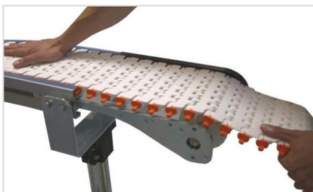
5. Die Kette in Laufrichtung in die Umlenkung einführen und nachschieben/ziehen, bis die Kette komplett durch den Förderer durchgezogen ist.
