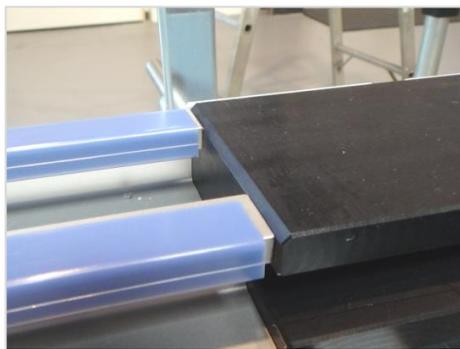
18. Vor Zwischenelementen oder nachfolgenden Elementen die Gleitleiste am Ende des Chassisprofils (in Laufrichtung gesehen) mit einem Abstand von ca. 5 mm montieren.
