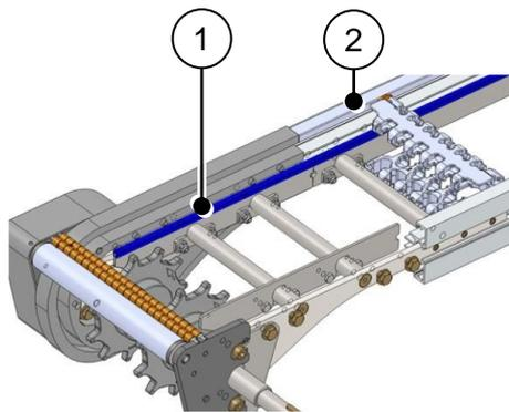
1. Die Gleitleisten (2) auf das Chassisprofil aufclipsen.
