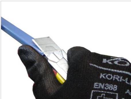
2. Gleitprofile auf Beschädigung prüfen.
