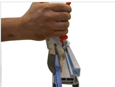
9. Gleitprofil am Ende des Halteprofils (in Laufrichtung gesehen) gerade abschneiden und bündig aufdrücken.
