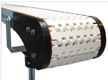
6. Seitenteil an der Umlenkung aufstecken.
