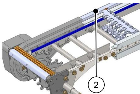
1. Die Gleitleisten (2) auf das Chassisprofil aufclipsen.
