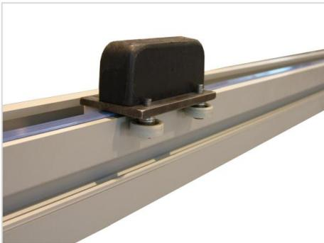
5. Gleitleiste mit dem Montagewerkzeug in Laufrichtung auf das Chassisprofil aufclipsen. Wellen in der Gleitleiste durch vollständiges (hörbares) Aufclipsen vermeiden.
