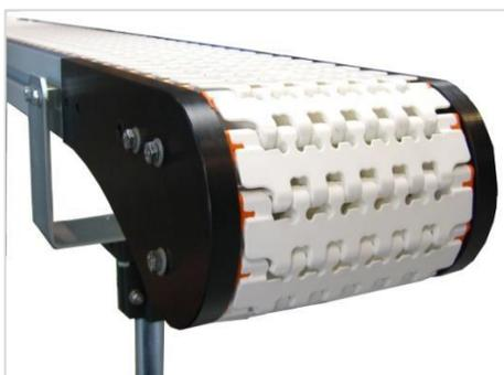
7. Seitenteil an der Umlenkung wieder montieren
