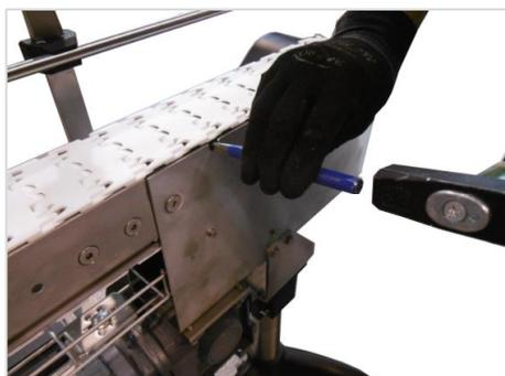
7. An der Montageöffnung den Kettenbolzen montieren und damit die Kette schließen.
