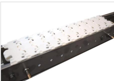
1. Mit einem kurzen Kettenstück den Lauf überprüfen.
