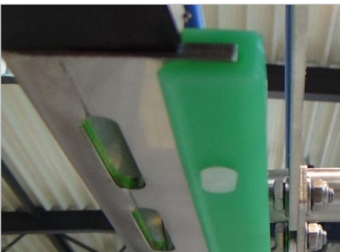
Abbildung 3: Montage der Kettenführungsprofile am Modulbandförderer
