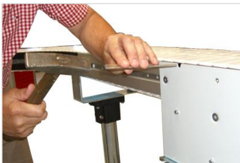
Abbildung 2: Montage des Gliederkettenbandes
