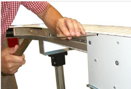
Abbildung 4: Reparatur oder Kettenspannung der Gliederkette anpassen
