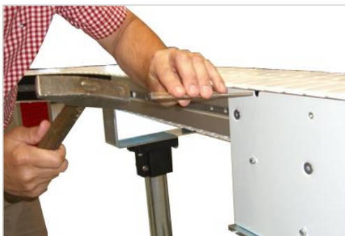
Abbildung 3: Montage des Gliederkettenbandes
